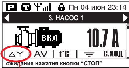
Выбрана схема пуска "звезда-треугольник"
