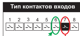
кнопка "Пуск", н.о. контакт; кнопка "Стоп", н.з. контакт
