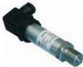
Предназначен для измерения и непрерывного преобразования избыточного давления нейтральных к титану и нержавеющей стали сред (газа, пара, жидкости) в унифицированный выходной сигнал постоянного тока 0...20(4...20)мА. Напряжение питания: 9...30 В, рабочая температура: до -40... +70°C.
