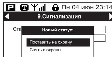
При нажатии кнопки [ВВОД] на экране появится меню постановки/снятия сигнализации. Необходимо выбрать нужный пункт и нажать кнопку [ВВОД]. Сигнализация будет установлена или снята.
