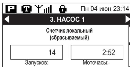
При дальнейшем нажатии кнопки [Вниз] будет отображено окно счетчика количества пусков двигателя за текущий час.
