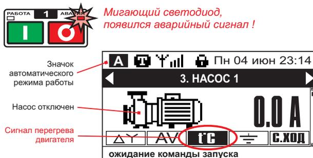
При понижении уровня воды в емкости ниже Уровня 3 происходит последовательное включение насосов. После получения команды запуска двигателя, в течение 0,5...1 секунды проверяются следующие параметры:
