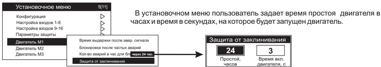
После очередного запуска насоса МК4 начинает отсчет времени его простоя. При превышении времени простоя выше заданного, МК4 кратковременно (на время от 1 до 30 секунд) запускает двигатель.
