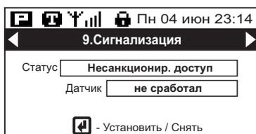
Будет включен прерывистый звуковой сигнал до снятия сигнализации с охраны или ее отключения. В окне <1.Состояние> появится предупреждение о срабатывании сигнализации. Дальнейшее открытие/закрытие двери не влияют на ее статус. Так как все константы хранятся в энергонезависимой памяти, то состояние сигнализации не изменяется при выключении/включении питания МК4.
