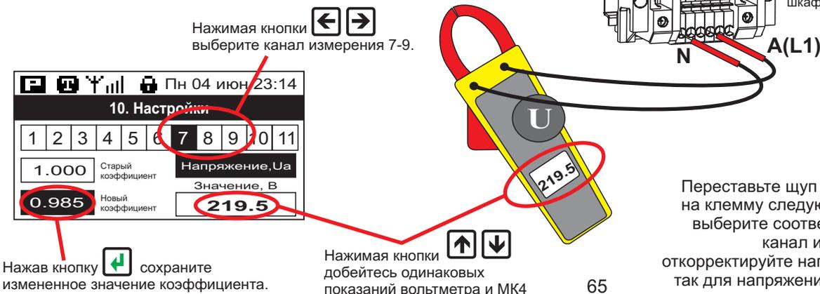
Переставьте щуп вольтметра на клемму следующей фазы, выберите соответствующий канал измерения и откорректируйте напряжение, и так для напряжений всех фаз.
