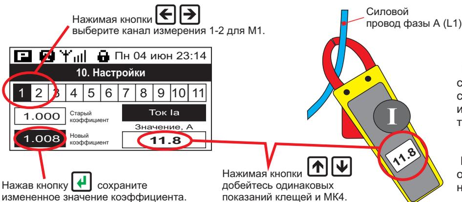
Переставьте клещи на провод следующей фазы(С), выберите соответствующий канал измерения(2) и откорректируйте ток следующей фазы(С).
