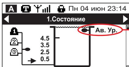
Сработал дискретный датчик аварийного уровня
