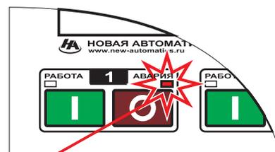
Получен аварийный сигнал с насоса. Светодиод "Авария" этого насоса мигает.
