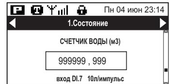
Так как заводское значение счетчика в МК4 нулевое, необходимо выполнить синхронизацию показаний МК4 и самого счетчика расхода воды. Синхронизацию следует выполнять при отключенных двигателях насосов, чтобы в процессе корректировки не было импульсов со счетчика.
