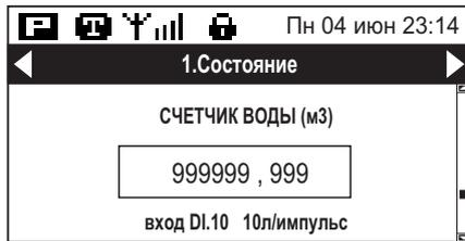
При дальнейшем нажатии кнопки [Вниз] будет отображено окно счетчика расхода воды с импульсным выходом.
