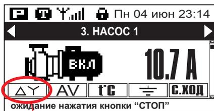
Выбрана схема пуска "звезда-треугольник"
