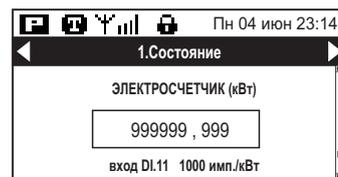
Так как заводское значение счетчика в МК4 нулевое, необходимо выполнить синхронизацию показаний МК4 и самого счетчика электроэнергии. Синхронизацию следует выполнять при отключенных двигателях насосов, чтобы в процессе корректировки не было импульсов со счетчика.
