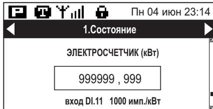
При дальнейшем нажатии кнопки [Вниз] будет отображено окно счетчика электроэнергии с импульсным выходом.
