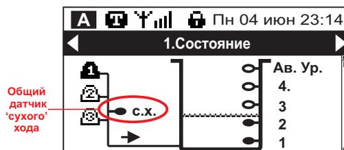
На главном экране **<1. Состояние>** будет выведен его значок и состояние (сработал/не сработал).
