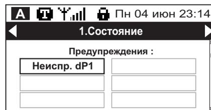
При одновременном отказе рабочего и резервного датчиков возможна аварийная остановка станции или один из трех режимов аварийной работы:
