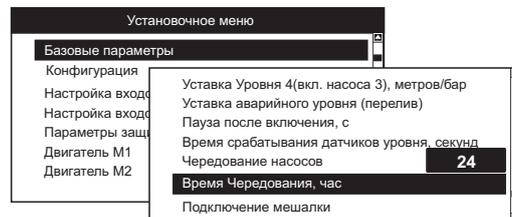
При нахождении какого-либо насоса в ремонте, при чередовании по времени игнорируется его время наработки и он становится последним в схеме.
