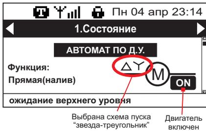
Выбрана схема пуска "звезда-треугольник" Двигатель включен
