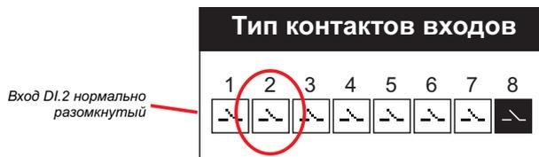
Если датчик "сухого" хода не предусмотрен, отключите его в установочном меню: **[Конфигурация]**-->**[Проверка датчика 'сухого' хода]** - значение "Не используется".
