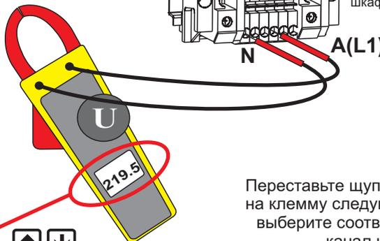
Переставьте щуп вольтметра на клемму следующей фазы, выберите соответствующий канал измерения и откорректируйте напряжение, и так для напряжений всех фаз.
