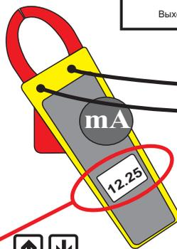
При наличии так называемых калибраторов сигнала (например, РЗУ-420), щупы калибратора подключаются вместо датчика давления(уровня), в калибраторе задается выходной ток и корректируются показания в МК3.
