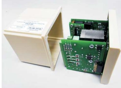
Снимите нижнюю плату и проверьте предохранители QF1 и QF2, установленные в держателях зеленого цвета. При неисправности замените их предохранителями 0.5А или 3.15А из прилагаемого комплекта ЗИП. Номинал предохранителей указан на плате рядом с держателем.
