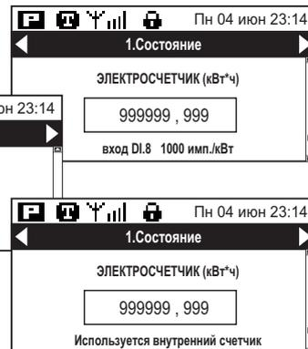
Вычисление затраченной электроэнергии при использовании внутреннего счетчика ведется по значениям измеренной Активной мощности электродвигателя. С высокой частотой измеренные значения мощности суммируются и выводятся на экран. При отключении питания МКЗ вычисления прекращаются.
