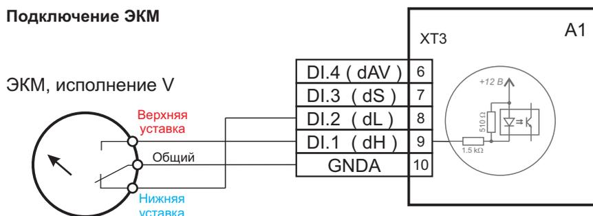
В п. 2.9 приведены сведения о существующих исполнениях ЭКМ. Установите нужный тип контактов нижнего и верхнего давления согласно данным из п.2.9, в противном случае возможно срабатывание аварии Ег.10 "Неправильное срабатывание датчиков уровня".
