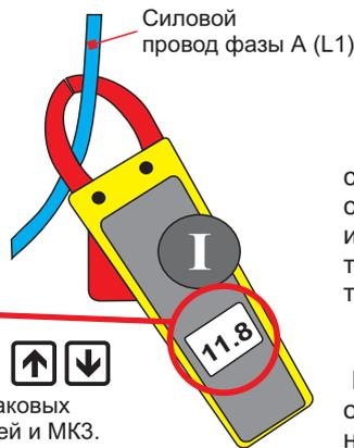
Переставьте клещи на провод следующей фазы, выберите соответствующий канал измерения и откорректируйте ток следующей фазы и так для токов всех фаз.
