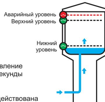
После окончания слива емкости (разомкнулся датчик нижнего уровня или давление ниже минимальной уставки) перед запуском электродвигателя в течение 0,5...1 секунды проверяются следующие параметры:
