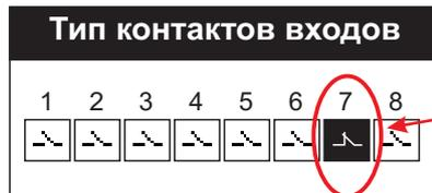
кнопка "Сброс аварии", н.з. контакт, Сброс произойдет при размыкании контакта
