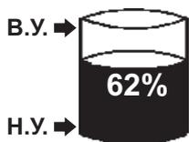
При использовании дискретных датчиков уровня (поплавокные, штыревые, ЭКМ и пр.) на экране будут показаны состояния контактов этих датчиков и ориентировочный уровень жидкости.
