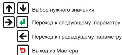
После выбора необходимых параметров, в конце Мастера будет предложено выполнить автонастройку токов защиты двигателя. Для автонастройки значений токов необходимо запустить двигатель кнопкой [ПУСК] и вывести на рабочий режим используемый агрегат.
