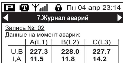
При еще одном нажатии кнопки [ВВОД] выводятся значения напряжений и токов двигателя на момент аварии.
