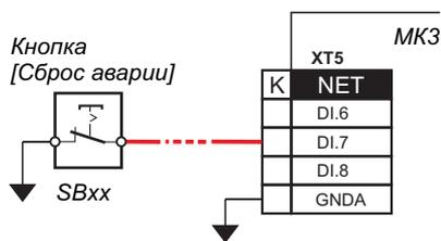
При использования одиночной кнопки [Сброс аварии], подключенной, например, к дискретному входу DI.7, в установочном меню **[Настройка входов 1-8] --> [Сигнал на входе DI.7]** измените значение на "Кн. Сброс аварии".
