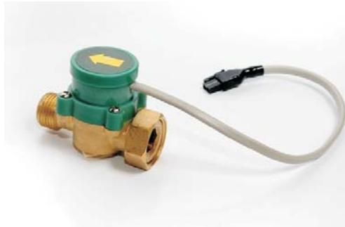
Без поступления жидкости пружина клапана разжимается, перемещая магнит в исходное положение, контакты герконового реле размыкаются и дают команду отключения насосной установки. Настройка срабатывания реле выполняется регулировочным винтом.
