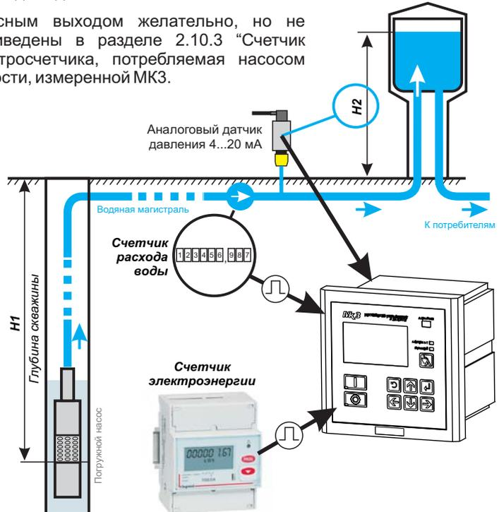
При использовании внешнего счетчика электроэнергии с импульсным выходом, затрачиваемая энергия считается по импульсам со счетчика. При использовании внутреннего счетчика, энергия рассчитывается по активной мощности электродвигателя (произведение напряжений, токов и коэффициента мощности  $\cos(\varphi)$  в единицу времени).
