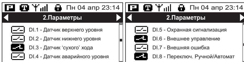
Отключите от клеммы возможно нерабочего входа провод данного датчика. Пиктограмма входа должна отобразить разомкнутое состояние. Отрезком провода замкните данный вход с общим проводом (GNDA). Пиктограмма должна отобразить замкнутый контакт. Если этого не произошло, данный вход поврежден, требуется ремонт на предприятии-изготовителе или в сервисном центре.
