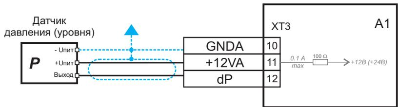
Возможна двух- или трехпроводная схема подключения датчика. Напряжение питания 12В(24В) нестабилизированное. Питание датчика ограничено током ~100 мА.
