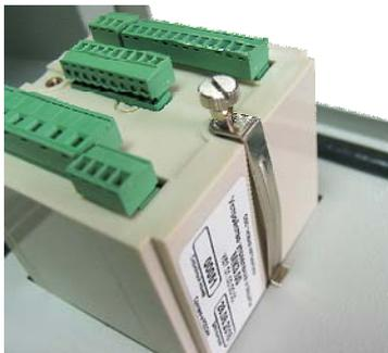
Установите прижимные планки на задней стенке прибора и притяните их к корпусу винтами так, чтобы прибор был плотно прижат к лицевой панели щита. Планки перед установкой слегка выгните внутрь, чтобы при затяжке винтов они не расходились в стороны.
