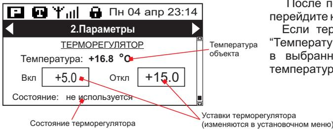
После подключения термодатчика подайте питание на МК3, и перейдите к пункту "Терморегулятор" в окне <2.Параметры>.
