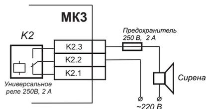
Если мощность внешних сигнальных приборов превышает нагрузочную способность контактов реле, то их подключение следует производить с использованием дополнительного реле или контактора.
