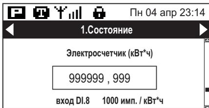
При правильной настройке в окне будет отображен номер используемого дискретного входа и установленное значение количества импульсов на один кВт\*ч счетчика. Показания счетчика на экране корректируются пользователем в разделе установочного меню **[Сброс параметров]**.
