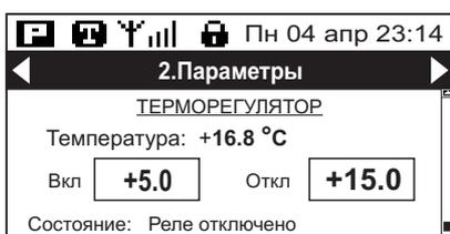
В последнем окне выводится параметры встроенного терморегулятора.
