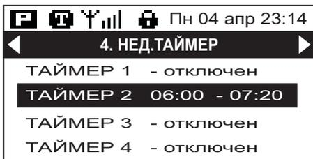
Нажимая кнопки [Влево], [Вправо] перейдите в окно <4.Недельный таймер>. В данном окне выводится состояние и параметры недельного таймера. Доступен просмотр и редактирование четырех программ работы, обозначенных на экране как Таймер 1 - Таймер 4.
