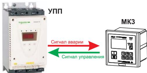
Когда требуется останов двигателя, МКЗ отключает реле К1, его контакты размыкаются и УПП получает команду останова.
