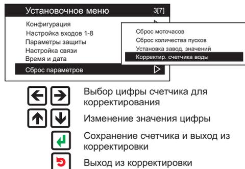
В процессе работы возможно незначительное расхождение показаний физического счетчика и его значений в МКЗ. Это может быть вызвано, например, выключением питания МКЗ при работающем насосе. После выключения питания насос по инерции работает еще некоторое время, в течение которого счетчик может послать импульс уже выключенному МКЗ. Соответственно, этот импульс не будет посчитан МКЗ. Следует периодически проводить проверку значений.
