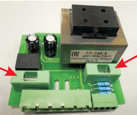
Предохранитель 3.15 А      Предохранитель 0.5 А
