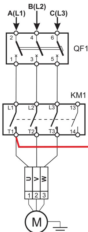
Для определения причины аварии, отключите питание шкафа с установленным МКЗ и отсоедините провод контроля изоляции от клеммы XT1.1 МКЗ. Оголенный наконечник провода изолируйте.
