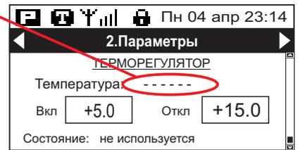
Если температура объекта отобразилась, перейдите в установочное меню и в пункте [Базовые параметры]-->[Термодатчик] выберите значение "Да".
