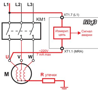
Принцип контроля: выпрямленное сетевое напряжение фазы А(L1) через токоограничительную и измерительную цепь подается на выходную клемму 'U' контактора. При выключенном контакторе эта цепь связана со всеми обмотками двигателя. При возникновении сильной утечки (сопротивление цепи < 20 кОм) запуск двигателя блокируется.
