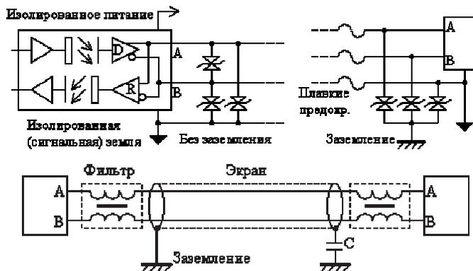
Некоторые разработчики рекомендуют для защиты от радиопомех дополнительно включать в нескольких местах между экраном и заземлением специальные высокочастотные конденсаторы емкостью 1...10 нФ.
