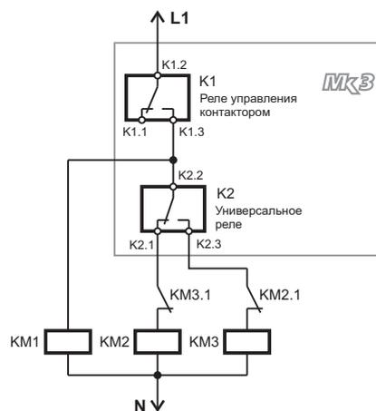
Для такой схемы включения электродвигателя в МКЗ используется реле включения двигателя K1 и одно из универсальных реле K2 ... K4 (на приведенной схеме используется реле K2).
