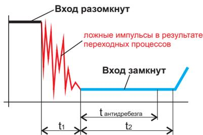
Если время замкнутого(или разомкнутого) состояния меньше времени уставки, сигнал не учитывается.
