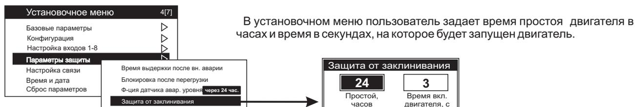
После очередного запуска двигателя МКЗ начинает отсчет времени его простоя. При превышении времени простоя выше заданного, МКЗ кратковременно (на время от 1 до 30 секунд) запускает двигатель.
