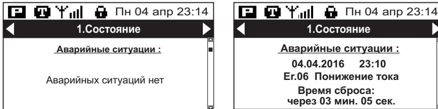
В этом окне при аварийной ситуации будет выведен код и расшифровка аварии, время возникновения, и ожидаемое время сброса данной аварии. Подробнее - см п.2.14 "Аварийные ситуации и индикация ошибок".
