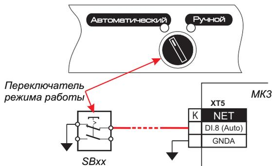
После подачи питания МКЗ проверяет заданный вход, и, в зависимости от его состояния, начнет работу в автоматическом или ручном режиме. Если вход разомкнут (установлен н.о. контакт) - осуществляется работа в ручном режиме.
