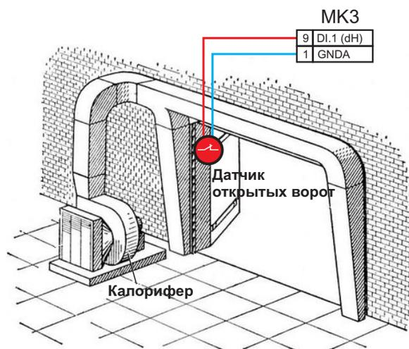
Режим работы по таймеру может использоваться, например, в зимнее время для периодического включения калорифера при открытии въездных ворот.
