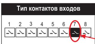
Тип контакта входа (для геркона - нормально разомкнутый) задается в пункте установочного меню **[Настройка входов 1-8]** --> **[Тип контактов входов]**.
