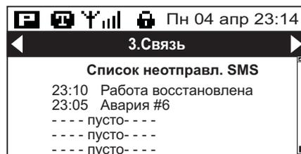
В МКЗ при использовании GSM-модема есть возможность автоматической рассылки sms-сообщений с показаниями счетчика расхода воды, количества произошедших пусков двигателя и время его наработки(моточасы). Это особенно актуально в случаях, где есть большое количество удаленных объектов и от них требуется получать ежедневный отчет, например, об отпущенном количестве воды.
