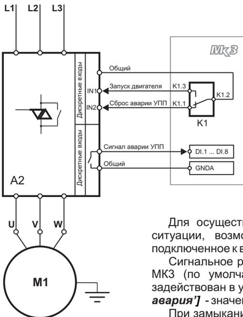
При настройке УПП пользователю необходимо задать номер дискретного входа УПП, замыкание которого запустит двигатель и номер входа для сброса возможной аварии УПП.
