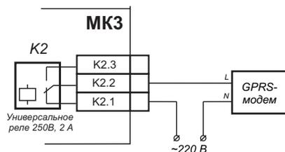
При возможном зависании модема прекратится поступление запросов от ПК(ПЛК) и через заданное время реле Kx включится, его н.з. контакты на 3 секунды разомкнут цепь питания GPRS-модема, после чего он теоретически перезагрузится и восстановит передачу данных. Если этого не произошло, и данные все-равно не поступают, через заданное время произойдет очередное включение реле и так до бесконечности или переключения на ручной режим.
