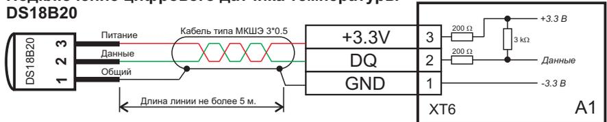
При подключении датчика **НЕ ДОПУСКАЕТСЯ** соединение общего провода датчика (GND) и заземляющей линии (PE) шкафа !
