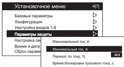
Время блокировки пускового тока (время запуска двигателя) задается индивидуально для каждого механизма. Для одних двигателей этот интервал составляет 1...2 секунды, для других, например, вытяжных вентиляторов, он может достигать 30 секунд и больше.
