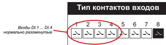
При использовании датчиков с другим состоянием контактов, измените их в этом меню.
