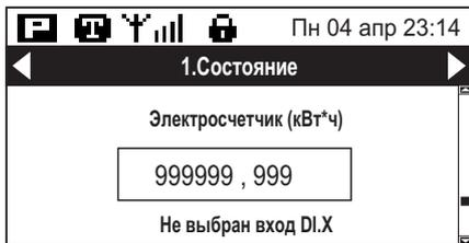
Если задан внешний электросчетчик и в разделе установочного меню **[Настройка входов 1-8]** не выбран дискретный вход, к которому подключен сигнал со счетчика, то будет отображено соответствующее сообщение.
