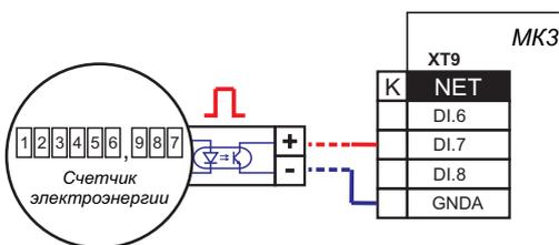
При подключении импульсного выхода счетчика, например, к дискретному входу DI.7, в установочном меню **[Настройка входов 1-8]** --> **[Сигнал на входе DI.7]** измените значение на "Сч. энергии, имп. ".
