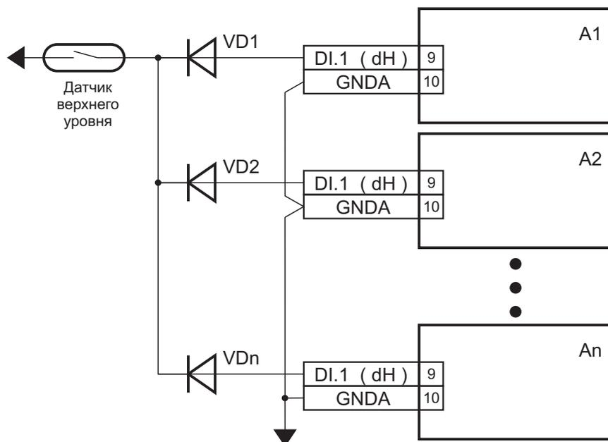
При подключении одного датчика уровня к нескольким устройствам в установочном меню каждого контроллера задайте один и тот же тип контактов датчика (н.о. или н.з.):
