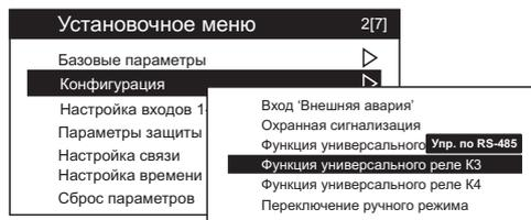
Для управления универсальными реле K2 ... K4 по RS-485 с удаленного ПК (ПЛК) необходимо в их функциях [Конфигурация]-->[Функция универсального реле Kx] установить значение "Управление по RS-485".
