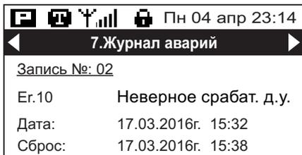
Строка с записью содержит время, дату, код и расшифровку кода случившейся аварии. При нажатии кнопки [ВВОД] выводится более полная информация о данной аварии. Выводится расшифровка кода аварии, время возникновения и время ее сброса.
