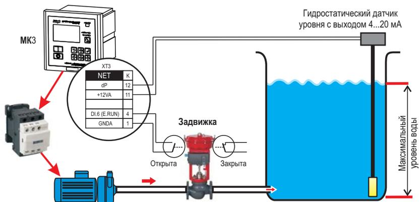
При закрытой задвижке контакт ее реле разомкнут, сигнала “Внешнее управление” нет.
