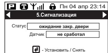
После закрытия двери (срабатывания датчика) звуковой сигнал прекратится и через 10 секунд станция будет поставлена на охрану.
