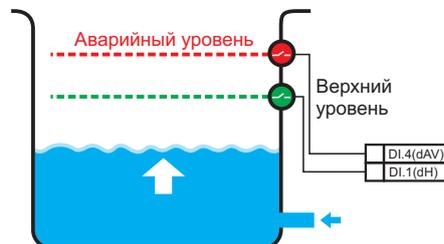
Датчик аварийного уровня dAV (если он используется) устанавливается в верхней точке емкости над датчиком верхнего уровня. Его задача - аварийно остановить налив или аварийно запустить откачку жидкости при дренаже.
