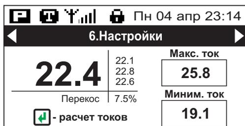
После того, как двигатель выведен на рабочий режим, нажатием кнопки [ВВОД] выполняется расчет значений токов защиты и их автоматический вывод в соответствующих полях.
