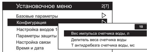
Если вес импульса счетчика дробный, то для его задания предусмотрен делитель в пункте установочного меню **[Конфигурация]** --> **[Делитель импульса счетчика воды]**. Его значение задается в диапазоне 1 ... 100.
