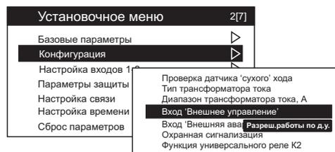
В автоматических режимах("Автоматический по датчикам уровня" и "Таймер") запуск двигателя будет осуществляться по сигналам датчика(-ов) уровня. При режимах работы "По командам от ПК" и "По командам из sms" состояние входа "Внешнее управление" игнорируется.
