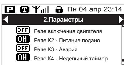
Далее отображается окно с состоянием конфигурируемых реле K1 ... K4. Выводятся значки с состоянием реле (включено/отключено) и функция реле, т.е. при каком событии оно должно включиться.
