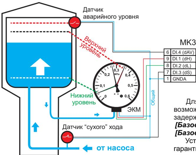
Если необходимо задействовать датчик аварийного уровня, в меню **[Параметры защиты]-->[Функция датчика аварийного уровня]** выберите из списка значение "Останов до снятия сигнала" или "Останов с выдержкой времени".
