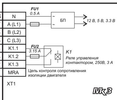
После неправильного подключения цепь довольно быстро отказывает после включения контактора.
