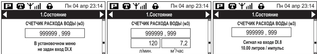
Если в разделе установочного меню **[Настройка входов 1-8]** не выбран дискретный вход, к которому подключен сигнал со счетчика, то будет отображено соответствующее сообщение.
