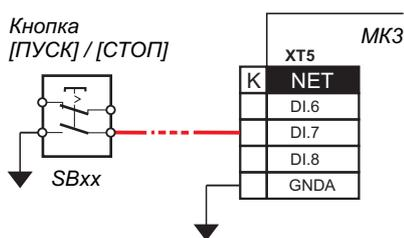
При использовании одиночной кнопки [ПУСК] / [СТОП], подключенной, например, к дискретному входу DI.6, в установочном меню **[Настройка входов 1-8] --> [Сигнал на входе DI.6]** измените значение на "Кн. Пуск/Стоп".
