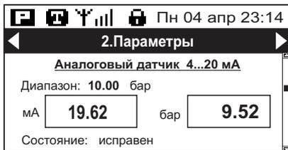
При дальнейшем нажатии кнопки [Вниз] выводятся параметры и состояние аналогового датчика давления или уровня, подключаемого к входу dP.
