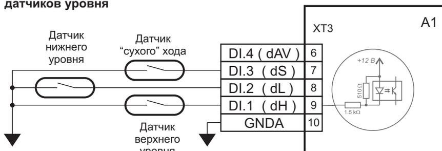
При подключении датчиков уровня уточните их состояние контактов (н.о. или н.з.) и укажите их тип в установочном меню МКЗ: **[Настройка входов 1-8] --> [Тип контактов входов].**
