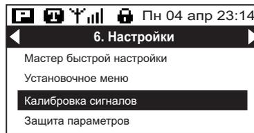
Перед процессом калибровки необходимо проверить правильность выбора датчиков тока и их диапазон в установочном меню. Если предполагается настройка токов электродвигателя, рекомендуется перейти на ручное управление, кнопкой [ПУСК] включить двигатель и вывести его на номинальный режим работы.
