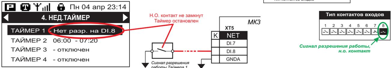
Аналогично производится настройка сигналов разрешения работы для остальных таймеров T2...T4.
