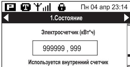
В МКЗ возможен некоммерческий учет потребленной электроэнергии по значениям токов, напряжений и коэффициента мощности (Подсчет и суммирование активной мощности). Для коммерческого учета необходимо использовать сертифицированные электросчетчики с импульсным выходом.
