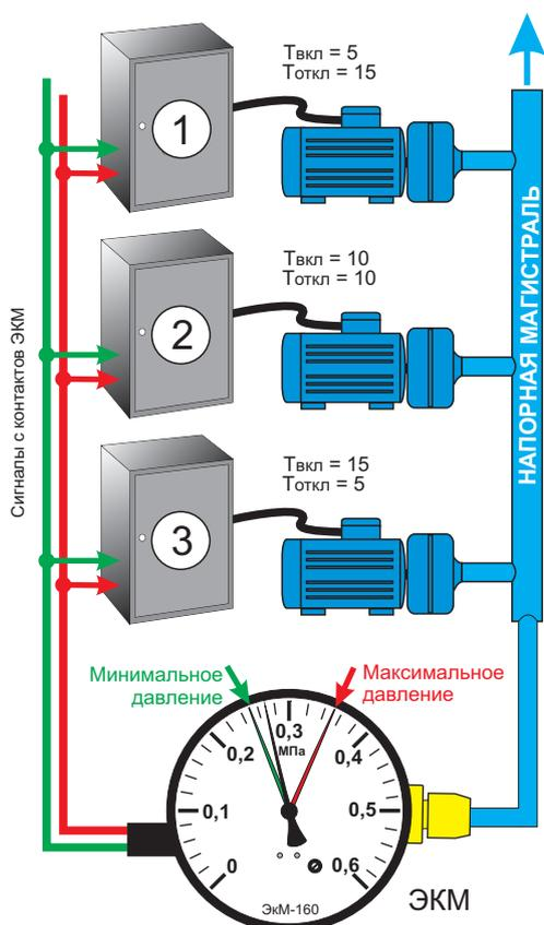
При давлении в магистрали ниже 2,5 бар замыкается нижний контакт ЭКМ. Все станции с МКЗ переходят на режим задержки включения. Через 5 секунд включится первая станция. Если производительности насоса не хватает, то еще через 5 секунд включится вторая станция.
