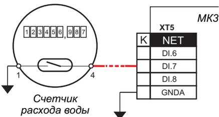
При подключении импульсного выхода счетчика, например, к дискретному входу DI.7, в установочном меню **[Настройка входов 1-8]** --> **[Сигнал на входе DI.7]** измените значение на "Счетчик импульсов".
