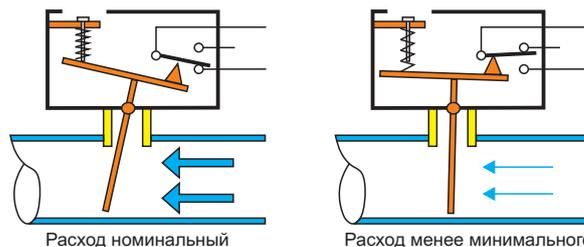
Датчик протока обычно встраивается в повысительные насосы с небольшой производительностью и выполняет функцию датчика «сухого» хода. В установочном меню МКЗ при использовании таких датчиков в пункте **[Конфигурация]-->[Проверка датчика сухого хода]** необходимо выбрать значение «Проверяется после запуска».
