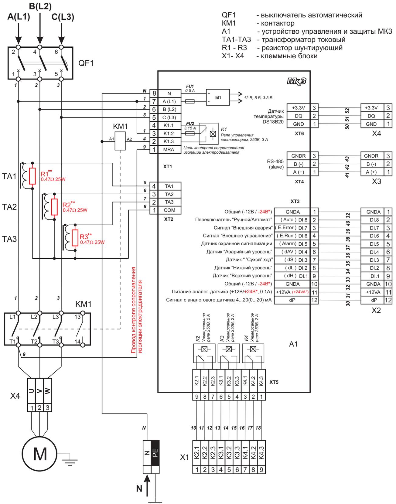
\* Для исполнений МКЗ с напряжением питания датчиков уровня =24В (указывается на маркировочной табличке устройства).
