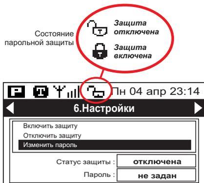
Для работы с парольной защитой в окне <6.Настройка> выбираем пункт "Защита параметров" и нажимаем кнопку [ВВОД].
