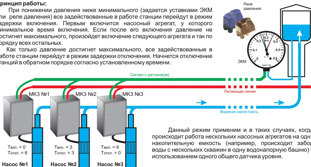
Данный режим применим и в таких случаях, когда происходит работа нескольких насосных агрегатов на одну накопительную емкость (например, происходит забор воды с нескольких скважин в одну водонапорную башню) с использованием одного общего датчика уровня.
