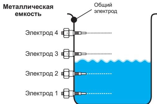
При контроле уровней в металлической емкости в качестве общего электрода может быть использован корпус емкости. Заземленный корпус емкости использовать не рекомендуется.
