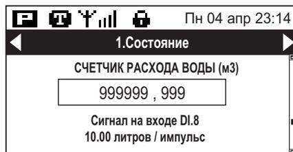
Так как заводское значение счетчика в МКЗ нулевое, необходимо выполнить синхронизацию показаний МКЗ и самого счетчика расхода воды. Синхронизацию следует выполнять при отключенном двигателе насоса, чтобы в процессе корректировки не было импульсов со счетчика.
