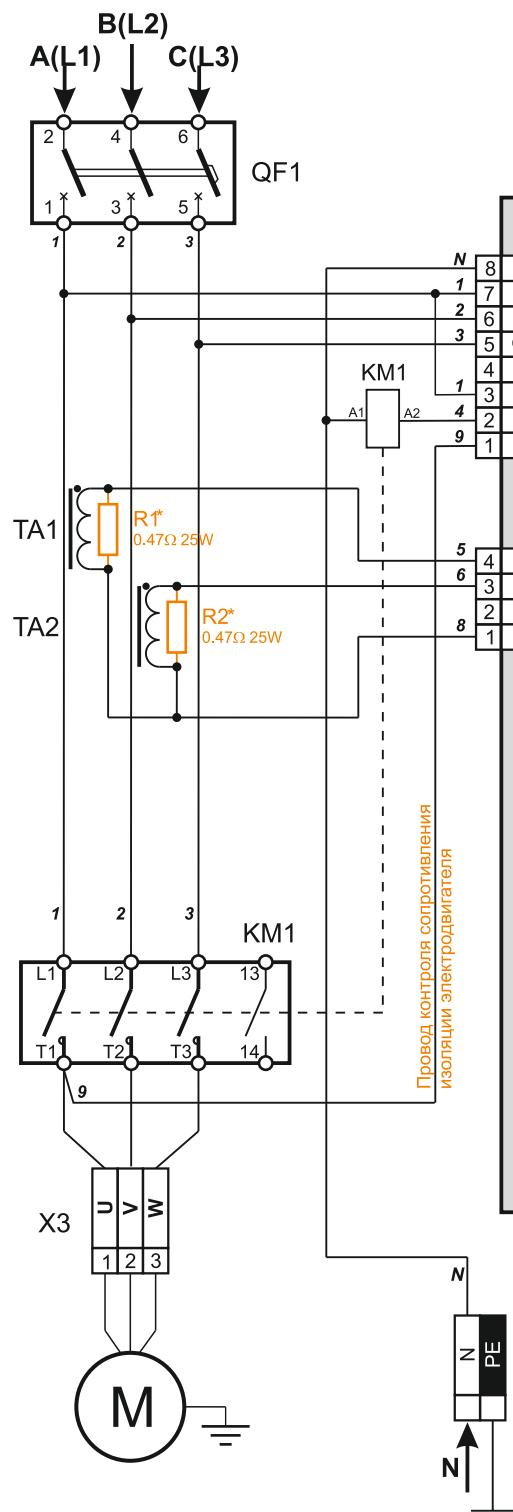
**СХЕМА ПОДКЛЮЧЕНИЯ ДАТЧИКОВ И ИСПОЛНИТЕЛЬНЫХ МЕХАНИЗМОВ НА ПРИМЕРЕ ШКАФА С ПРЯМЫМ ПУСКОМ**
