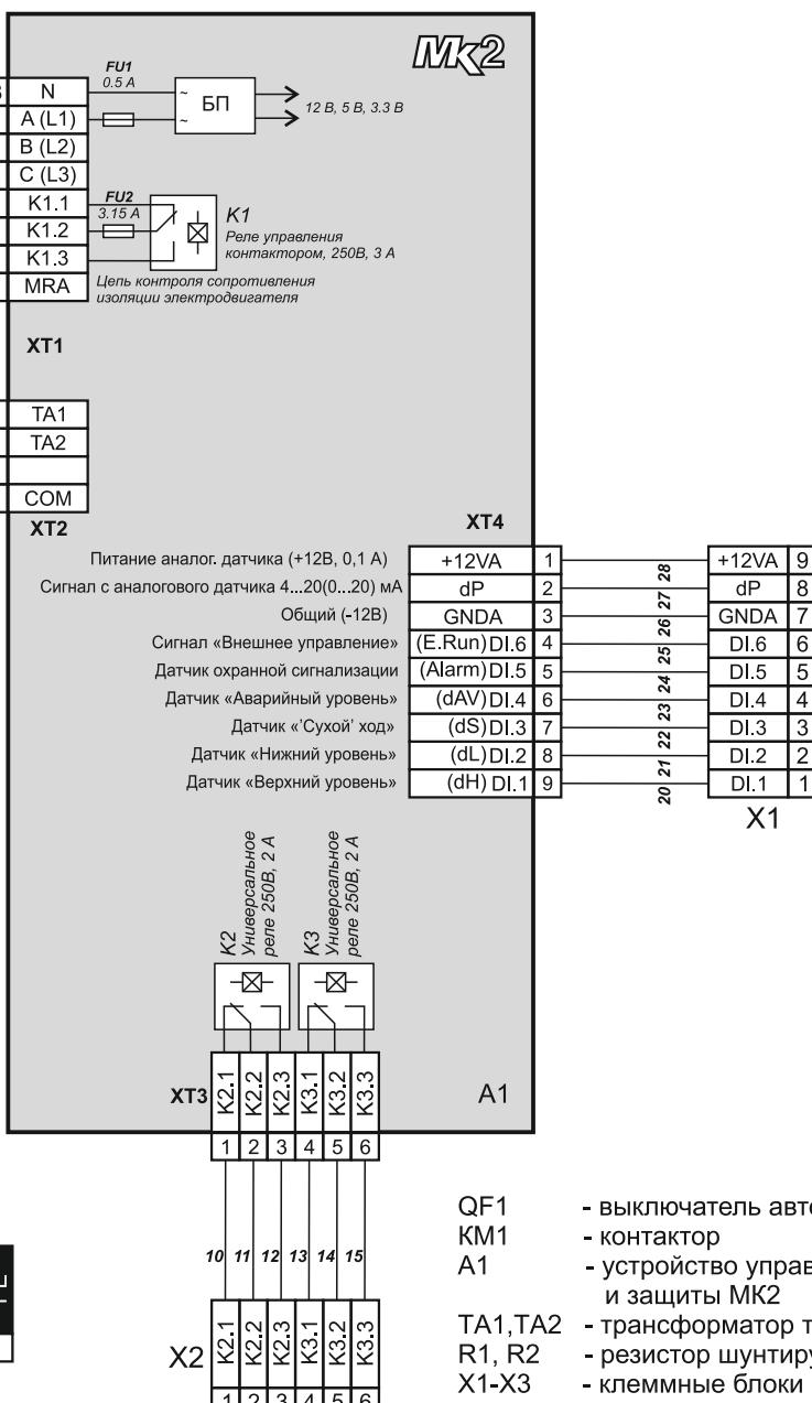
\* При использовании трансформаторов тока типа Т03-120А резисторы R1, R2 не устанавливаются. При использовании трансформаторов тока с унифицированным токовым выходом 5А номинал резисторов R1, R2: 0,47W 25W.
